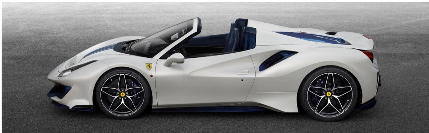
Pas de surprise, la base mécanique reste identique avec un V8 biturbo de 720 ch proposant un rapport poids/puissance de 1,92 kg/cv. Ceci est une véritable prouesse puisque le surpoids dû aux renforts n'est que d'une centaine de kilos pour atteindre un poids total de 1380 kg. Pour rappel, la 488 Pista "normale" pesait déjà 100 kg de moins que la 488 GTB de série.
