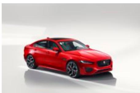
Les motorisations essence proposées reposent sur le bloc Ingenium de 2.0 litres, disponible en version 250 ou 300 chevaux. Côté diesel, il est possible d'opter pour le D180 délivrant, comme son nom l'indique, 180 ch pour un couple de 430 Nm.
