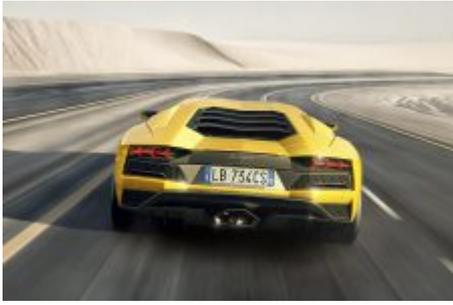
Sur le plan aérodynamique, la voiture a été passablement modifiée pour offrir une force d'appui à l'avant 130% supérieure au modèle classique. A l'arrière, suivant le braquage de l'aileron, la force d'appui a été augmentée jusqu'à 50%.
