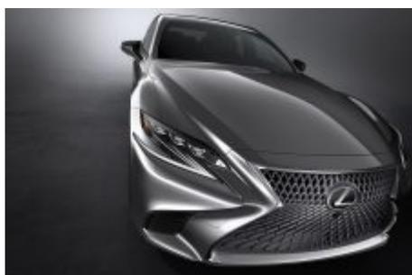
Côté corps, la LS année-modèle 2018 se rapproche du sol de 15 mm (avec un capot et un coffre abaissés de 30 et 41 mm respectivement) et voit son empattement s'allonger de 35 mm, la longueur totale étant de 5'235 mm. Construite sur la plateforme maison GA-L (global architecture for luxury vehicles), la LS profitera de la dernière mouture de contrôle de châssis, via le
