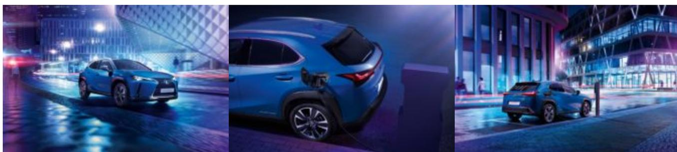
Le Lexus UX 300e promet une autonomie de 400km selon la norme NEDC. A l'avant du véhicule se cache un moteur électrique qui développe 150 kW et un couple maximum de 300 Nm. Les batteries sont elles situées dans le plancher de la voiture assurant un centre de gravité relativement bas pour proposer un bon comportement routier.
