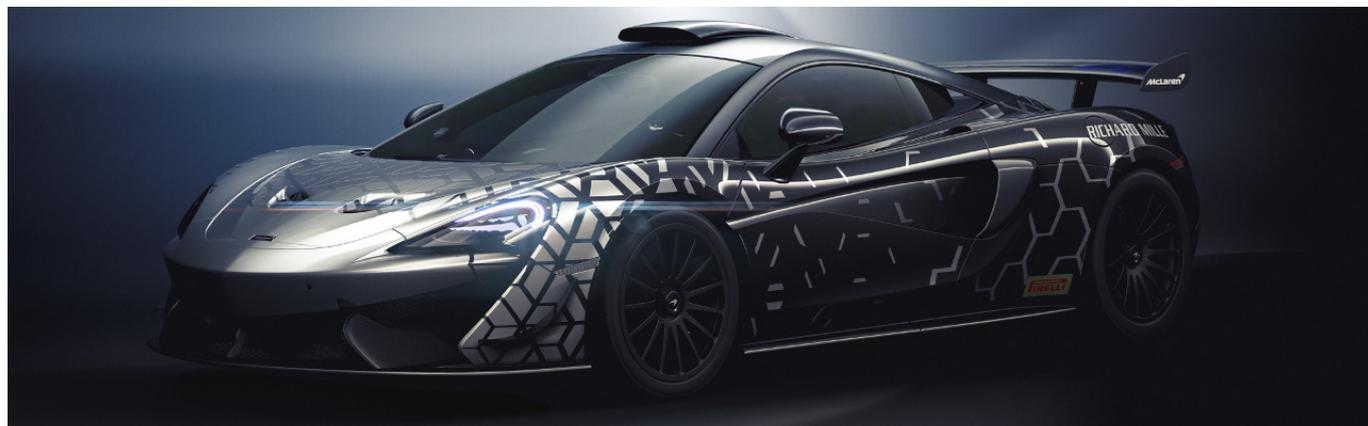
On retrouve dans la bête le V8 biturbo de 3,8 litres qui développe assez logiquement 620 chevaux et 620 Nm. L'aérodynamique et le châssis sont largement partagés avec la 570S GT4. Les appendices aéro permettent de créer un appui de 185 kg à 250 km/h, tandis que les amortisseurs venant de la GT4 assurent un grip mécanique accru. Le dispositif est complété par des pneus Pirelli P Zero Trofeo R de série, tandis que des gommes slicks sont équipables en option, pour une utilisation piste uniquement.
