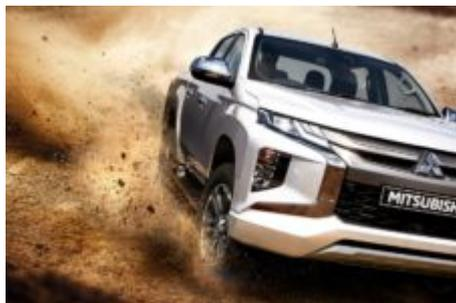
Pas d'évolution au niveau de la motorisation (4 cylindres diesel 2.4 litres de 180 ch), alors que la boîte de vitesse automatique gagne 1 rapport et propose maintenant 6 vitesses. Deux systèmes de traction intégrale sont proposés : le Super-Select 4WD (optimise la traction la manoeuvrabilité) et le système Easy-Select 4WD (simplifie la commutation entre les modes de traction en fonction de la surface). Ces deux systèmes offrent des réglages Gravel, Mud/Snow, Sand et Rock.
