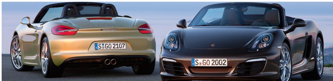
Pour la première fois depuis son lancement en 1996, le Boxster est revu de fond en comble par les ingénieurs de Stuttgart. En résulte un nouveau roadster à l'empattement allongé, aux voies élargies, aux porte-à-faux réduits et une ligne globalement plus ramassée et racée, rappelant sous certains angles la Supercar Carrera GT. Les performances dynamiques devraient également être au rendez-vous avec l'adoption d'une nouvelle direction.
