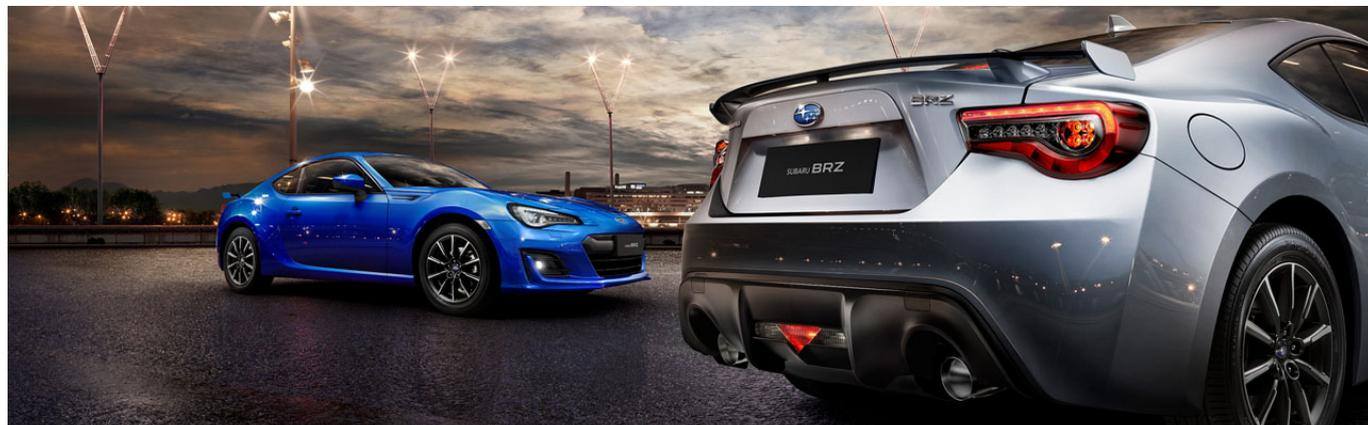
Pour ce coupé sportif 2+2 au design plutôt réussi, le constructeur japonais allait déroger à sa règle de la traction intégrale. En effet, seules les roues arrières entraînent cette voiture au centre de gravité placé proche du sol. En 2017, la BRZ sera toujours équipée du moteur boxer 4 cylindres produisant 200 ch pour un couple de 205 Nm. Pourvu de nouvelles soupapes et d'arbres à cames redessinés, les ingénieurs sont parvenus à réduire les frictions internes du moteur.
