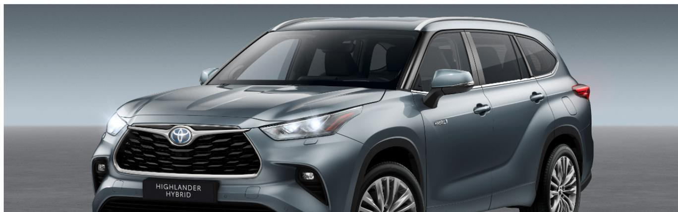
Toyota oblige, la motorisation est en mode tout-hybride (auto-rechargeable). Le groupe motopropulseur s'appuie sur un bloc essence de 2,5 litres à cycle Atkinson qui se combine avec deux moteurs électriques, chacun placé sur un essieu. La transmission est intégrale et dite AWD-i (i pour intelligente), permettant une variation de la distribution du couple entre l'avant et l'arrière de 100-0 à 20-80.
