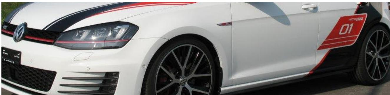
Surbaissée de 30 mm, élargie de 20 mm à l'arrière et dotée d'embouts spécifiques Siebring, la Golf GTI Performance Limited Edition passe à 274 CV, contre 230 pour la version de base. Un autocollant "Limited Edition" avec numérotation de 1 à 100 finit de signaler l'apanage de cette déclinaison.
