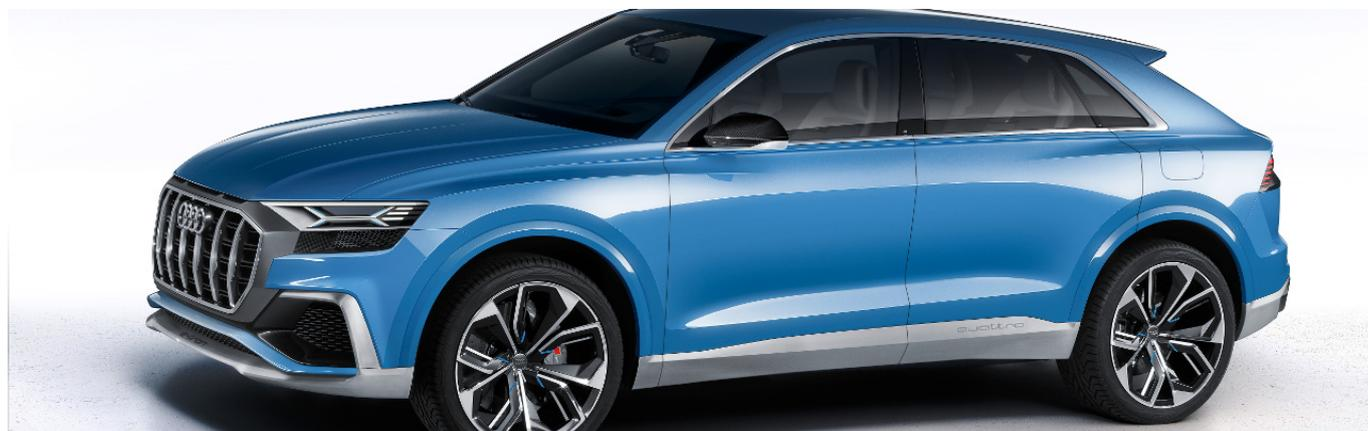
S'agissant de se positionner parmi les SUV premium XL, Audi choisit le luxe et la technologie hybride. Le Q8 concept est animé par un moteur thermique 3.0 TFSI couplé à une motorisation électrique qui développe une puissance de 330 kW (soit presque 450 ch) pour un couple 330 Nm. L'ensemble est associé à une boîte tiptronic à 8 rapports. Le 0-100 km/h est annoncé en 5.4 secondes et la vitesse maximale limitée à 250 km/h.
