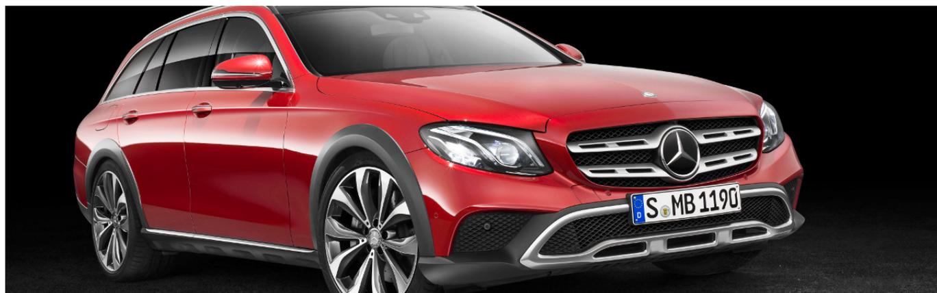
Issue de la série E, la marque propose pour commencer une seule motorisation diesel pour cette déclinaison All-Terrain. Il s'agit du 4 cylindres de 1'950 cm<sup>3</sup> avec 194 ch à 3'800 t/min et un couple de 400 Nm disponible entre 1'600 et 2'800 t/min. Plus tard, c'est le 6 cylindres diesel qui fera son apparition et tous les modèles sont proposés avec la boîte automatique 9G-TRONIC à 9 rapports.
