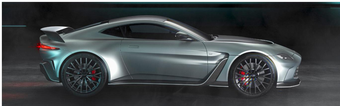
Derrière cette icône, tout ce que la marque sait faire de mieux avec le mythique V12 biturbo de 5.2 litres. Les spécifications sont à l'avenant avec une puissance de 700 ch à 6'500 t/min et un couple de 753 Nm entre 1'800 et 6'000 t/min. La transmission est assurée par une boîte automatique ZF à 8 rapports avec un différentiel à glissement limité.
