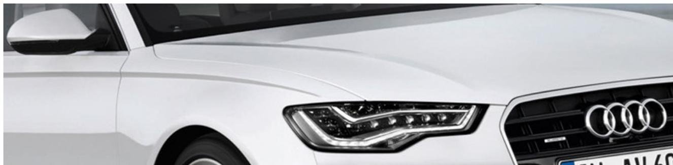
La septième génération du break A6 mesure 4m93, soit 13 cm de plus que la première A6 Avant lancée en 1994. Ce nouveau modèle propose un look sportif dû à la ligne de toit relativement basse. Avec 20% d'éléments en aluminium, le constructeur annonce un poids plume de 1'640 kg à vide pour le modèle 2.0 TDI, soit 70 kg de moins que la version précédente.
