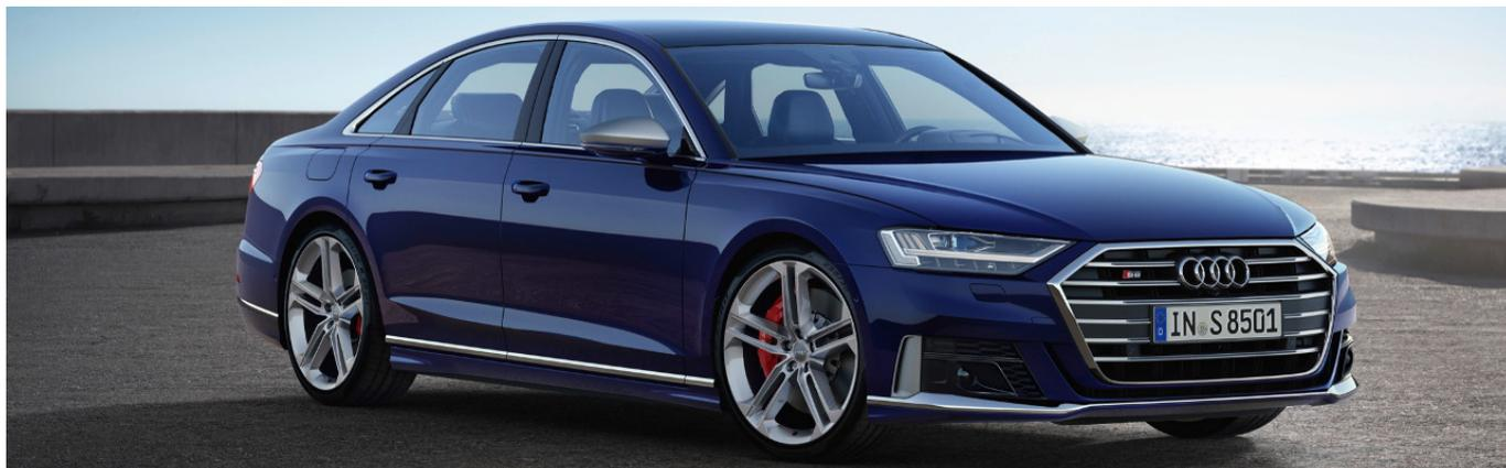
Nous avons proposé au printemps dernier l'A8 55 TFSI, avec son "petit" V6, et maintenant Audi annonce la version musclée et sportive de son modèle amiral équipée du V8 biturbo de 563 ch et 800 Nm. Dans un souci d'efficacité, ce moteur peut également désactiver un banc de cylindres afin d'économiser du carburant.
