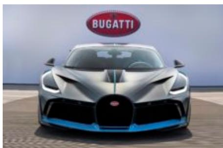
La base mécanique n'est pas inconnue de nos lecteurs. La Divo est une extrapolation de la Chiron, pesant 35 kilos de moins, apportant 90 kilos d'appui en plus et améliorant le temps sur la piste de Nardo de 8 secondes (!). La Bugatti Divo devient la voiture de tous les superlatifs : 1'500 ch, vitesse de pointe bridée
