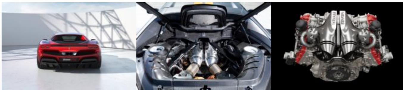
Peu importe, une nouvelle Ferrari c'est toujours un événement et ce modèle réunit un concentré de technologies avec un moteur V6 de 2'992 cm<sup>3</sup>, une puissance de 663 ch à 8'000 t/min pour le moteur thermique et un total de 830 ch avec le moteur électrique. Pour le couple, c'est 740 Nm à 6'250 t/min et la zone rouge se situe à 8'500 t/min. Le tout est couplé à une boîte à double embrayage à 8 rapports.
