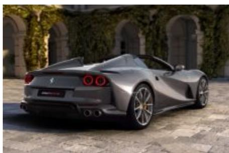
Côté design, la 812 GTS intègre essentiellement des modifications liées au passage en cabriolet, avec un capot arrière revu, lequel s'habille d'une double bulle qui abrite le pavillon de toit rigide, qui se déploie et se rétracte en 14 secondes, jusqu'à 45 km/h. Un ensemble d'éléments aérodynamiques ont ajoutées, dont des clapets en L sur le pare-brise, similaire à ceux équipant la LaFerrari Aperta, viennent guider les flux d'air pour limiter les perturbations dans l'habitacle.
