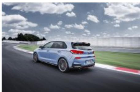
Pour aiguïser le caractère sportif de la cinq-portes, les hommes de Séoul ont intégré à l’électronique embarquée un système de « launch control » qui, lorsque le mode « N » est activé, permet d’accomplir un départ arrêté de manière automatique à régime optimal. S’ajoute à cela une fonction « Rev Matching », qui rend des changements de vitesses plus courts et sans perte de couple.
