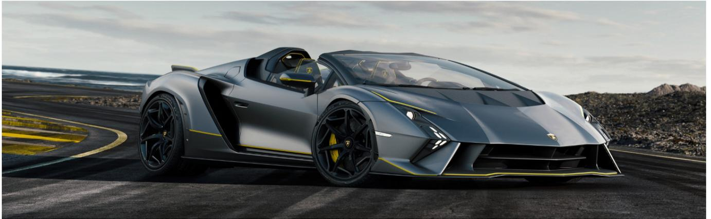
Avant de parler de l'extérieur, il faut vite parler de ce qui bat dans le coeur de ce coupé et roadster: V12 de 6.5 litres avec une puissance de 780 ch et un couple de 720 Nm. Le tout repose sur une boîte 7 vitesses ISR et de quatre roues motrices dans un châssis d'Aventador.
