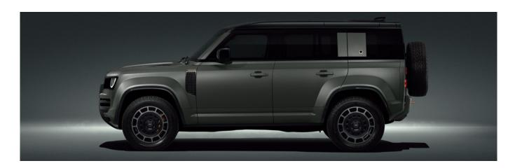
Face à ce nouveau venu, le Defender V8 essayé à l'automne dernier ressemble à un agneau. Pour commencer, le Defender OCTA est équipé d'un moteur V8 biturbo de 4.4 litres à hybridation légère qui développe 635 chevaux pour un couple maximum de 750 Nm. Une telle motorisation lui permet d'atteindre une vitesse maximale de 250 km/h et d'accélérer de 0 à 100 km/h en 4,0 secondes.
