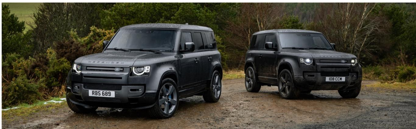
Pouvant être équipé sur le châssis 90 et 110, le bloc à huit pattes de 5 litres développe 525 chevaux et 625 Nm de couple. Couplé à une boîte automatique 8 rapports, il permet d'améliorer considérablement les performances, avec un 0 à 100 qui tombe 5,2 secondes et une vitesse maximale affichant 240 km/h. Le caractère dynamique est aussi amélioré, avec l'équipement de barres antiroulis plus grosses et d'un différentiel arrière plus performant.
