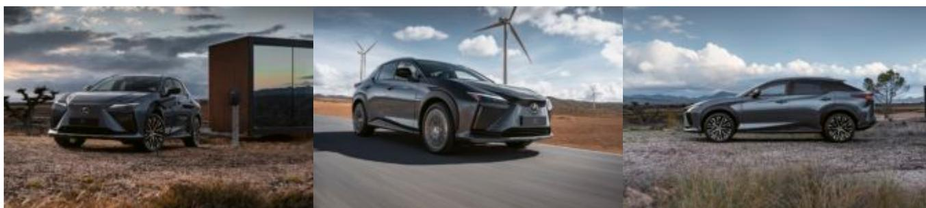
Doté d'un moteur d'une puissance de 150 kW sur l'axe avant et d'un autre moteur de 80 kW sur l'axe arrière, la puissance totale est de 230 kW et l'électronique permet de répartir le couple sur chaque roue. Du côté de l'autonomie, le constructeur a muni la voiture d'une batterie de 71.4 kWh ce qui devrait permettre d'offrir une autonomie légèrement supérieur à 400 km.
