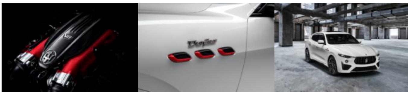
Le beau moulin développe 580 chevaux à 6'250 t/min et un couple maximal de 730 Nm. Couplé à une boîte ZF à 8 rapports, il permet aux deux modèles
