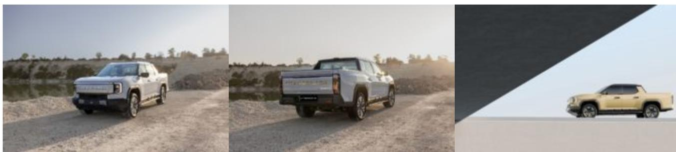
Avec une longueur de 5,50 mètres, soit 80 cm de moins qu'un Ford F150 Lightning, son seul véritable concurrent, dont nous vous avons proposé un essai complet récemment, le eTERRON 9 présente une capacité de charge utile de 620 kg et une surface de chargement extensible à 2,40 mètres grâce à une paroi arrière rabattable. Un coffre avant de 236 litres est disponible pour des bagages supplémentaires. Le pick-up dispose également d'un crochet d'attelage avec une
