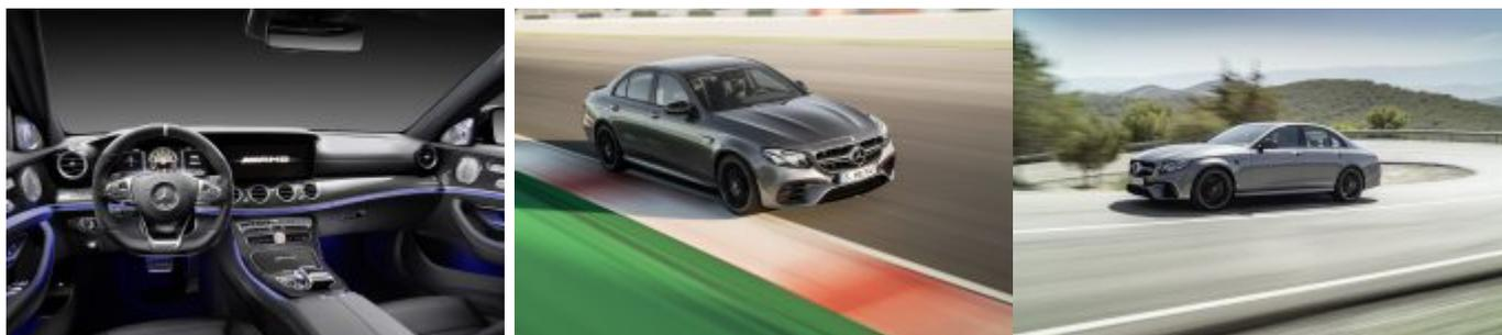
Afin de différencier ces modèles AMG d'une Classe E « normale », les E 63 seront reconnaissables grâce à une face avant distinctive et à un arrière rendu plus musclé, élargi de 27 mm, et avec des passages de roues modifiés pour recevoir les nouvelles roues de 19 pouces (20 pour la E 63 S) en 295 de large.
