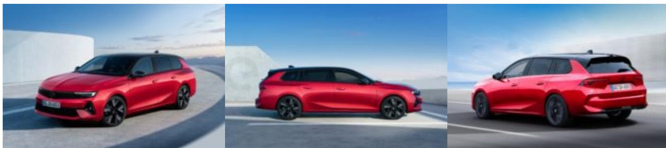
La nouvelle Astra Sports Tourer Electric est, comme son nom le laisse présager, une version totalement électrique. Le moteur d'une puissance de 115 kW et un couple de 270 NM permet d'atteindre 170 km/h. Au niveau autonomie, grâce à une batterie de 54 kWh, la marque annonce 413 km selon la norme WLTP.
