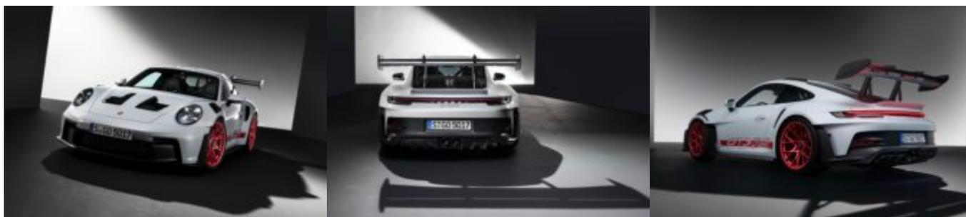
Les éléments liés à l’aérodynamique ont été largement revus et ils offrent des appuis importants avec une déportance totale de 409 kg à 200 km/h. Le petit coffre avant est maintenant occupé par un radiateur central et les freins ont été renforcés.
