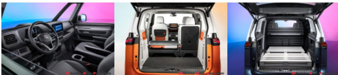
Le bus VW a toujours l'avantage de passer sous la toise des 2 mètres avec 1'937 ou 1'938 mm de haut selon l'équipement. Si vous pensez être à l'étroit dans la version 5 places, le châssis long existe pour ajouter deux places supplémentaires ; le volume de chargement va de 1'121 litres à 2'205 litres. Le jumeau utilitaire ID.Buzz Cargo en profite également, deux europalettes y logent avec 120 cm de large entre les passages de roues et bien plus de 160 cm de longueur de chargement.
