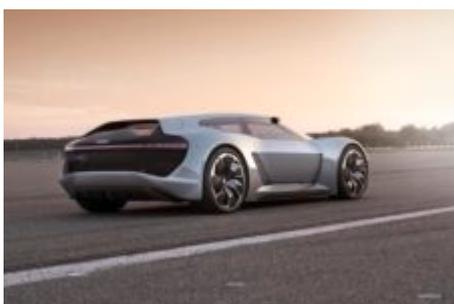
La traction électrique de la PB18 e-tron se distille au travers de trois moteurs électriques (un à l'avant et deux à l'arrière...) qui fournissent jusqu'à 150 kW sur l'essieu avant et jusqu'à 350 kW (!) à l'arrière. La puissance cumulée maximale de 500 kW permet un 0 à 100 km/h en deux secondes seulement.
