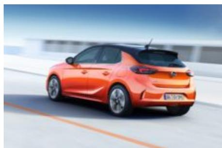
Cette Opel Corsa-e est équipée d'une motorisation développant 136 ch pour 260 Nm de couple, et promet une autonomie de 330 km en cycle WLTP. Cette valeur est encore provisoire en attendant l'homologation définitive de cette petite citadine. C'est d'ailleurs cette version électrique qui ouvrira les carnets de
