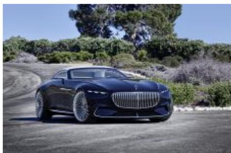
Pour animer cette belle allemande, les ingénieurs l'ont équipé d'une motorisation électrique qui développe 550 kW, soit 750 ch. Les batteries sont installées dans le plancher de l'auto et promettent une autonomie de plus de 500 km (selon normes NEDC).
