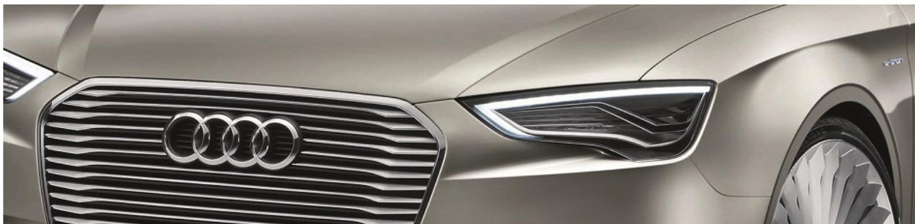
Cette Audi A3 e-tron concept représente tout le savoir-faire technologique de la marque d'Ingolstadt. La motorisation de type hybride Plug-in combine un moteur 1.4 TFSI de 211 CV et un moteur électrique de 27 CV, pour proposer une puissance totale de 238 CV et annoncer le 0-100 km/h en 6,8 secondes. La consommation moyenne serait de 2,2 l/100 km, et les batteries permettraient de rouler en mode 100% électrique sur 54 km.
