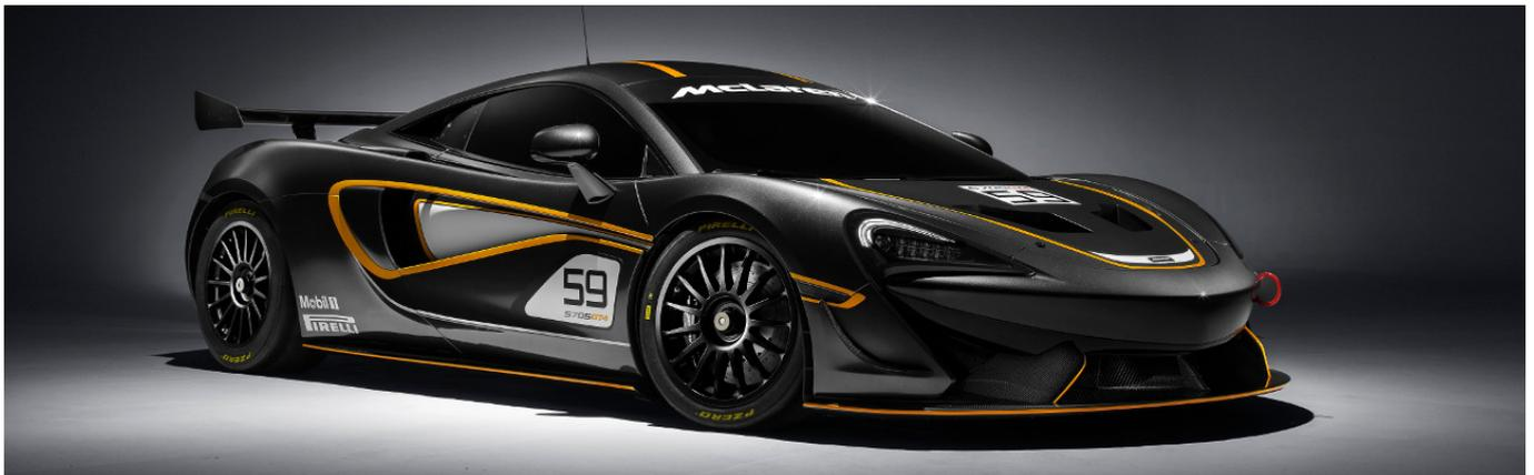
Comme son nom l'indique, la 570S GT4 répondra aux normes GT4, avec l'apport, entre autres, d'un massif aileron arrière et d'un diffuseur avant plus large.
